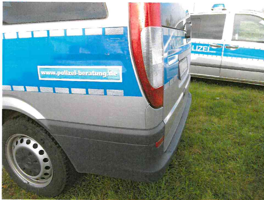
Bild 5 : Seitenteil hinten links eingedrückt Stoßhecke hinten links zerkratzt
